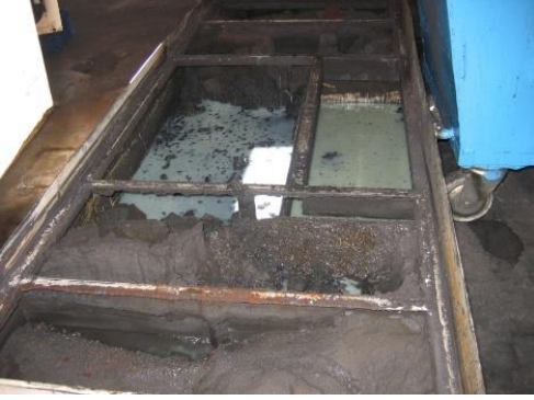
Tankı kaplar. Kesme sıvısı hacmini düşürür. Kesme sıvısının bozulmasına sebep olur.
